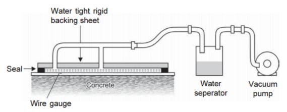
هناك علاقة طردية بين زيادة المقاومة للخرسانة وكمية المياه التي يتم إزالتها حتى تصل إلى القيمة الحرجة والتي بعدها لا توجد زيادة ملموسة في المقاومة. وبناءً عليه ينصح عدم الإطالة في زيادة وقت العملية كتوقع لزيادة أكثر في المقاومة. تعتمد القيمة الحرجة بشكل أساسي على سمك الخرسانة ونسبة الخلطة.
